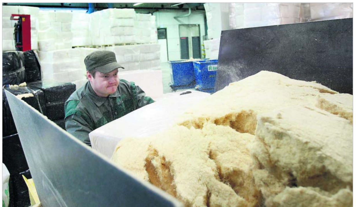
Marko Markku syöttää kuusihioketta tuotantolinjaan. Lopputuote on kuohkeaa eristelevyä.
